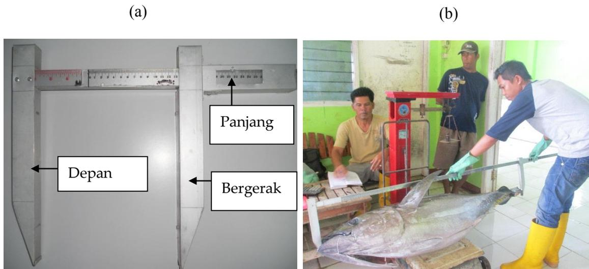
Gambar 5: Kaliper. (a) Pengukuran dibaca dari panah kecil yang tebal. Lengan depan dan bergerak dari kaliper ditandai dan (b) demonstrasi penggunaan kaliper. (© MPDI)
